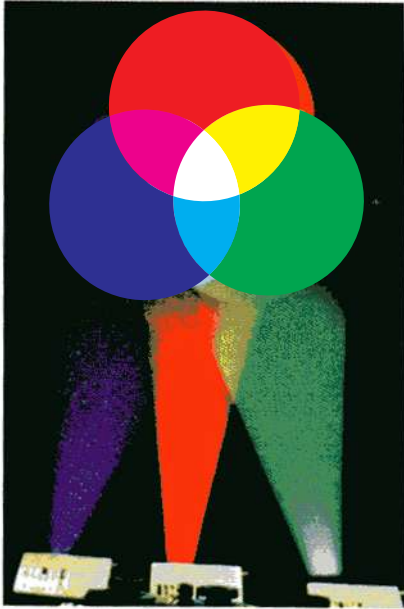
Combinación aditiva realizada por la proyección de círculos luminosos violeta, rojo y verde.
